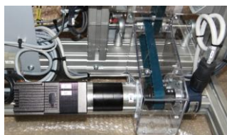
Motorisation Brushless, courroie crantée et codeur incrémental
