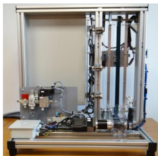
Partie opérative à technologie électropneumatique
