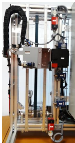
Partie opérative avec interrupteurs de sécurité et de sécurité à verrouillage
