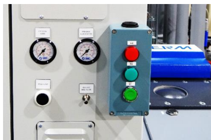
Contrôles pressions vérin et alimentation, Bouton et voyants marche/arrêt
