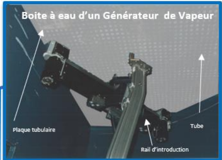
BRAS BETA en situation de d'introduction dans la boîte à eau d'un Générateur de Vapeur
