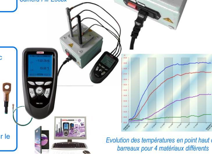
Evolution des températures en point haut des barreaux pour 4 matériaux différents
