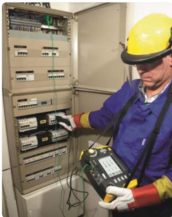
Dans le domestique, le tertiaire ou l'industrie, les nouveaux contrôleurs d'installation multifonction permettent de **vérifier la conformité d'une installation électrique selon les normes en vigueur**. Cette vérification est obligatoire pour obtenir quel que soit le type de bâtiment testé (domestique, bâtiment public, industrie...) l'assurance d'une installation ne présentant aucun danger.
