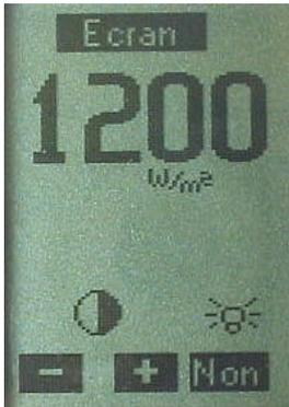
Régler le contraste et activer le rétroéclairage
