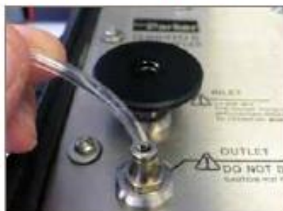
Fixez le tuyau souple de sortie (Ø 4 mm)
