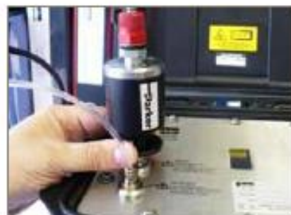
Pour retirer le réducteur de pression (PRV), appuyez sur le connecteur tout en soulevant le réducteur de pression.
