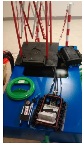
Vue du châssis trottoir avec regard de raccordement, boîtier d'adduction opérateur, pompe de test d'étanchéité, aiguille avec émerillon... (Dans FF12 déploiement horizontal)
