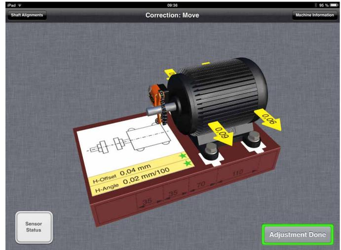
Le réglage dans le plan horizontal se fait en temps réel grâce à des flèches indiquant l'action à faire. Les résultats d'alignement sont mis à jour en temps réel pour voir si vous êtes dans les tolérances d'alignement.
