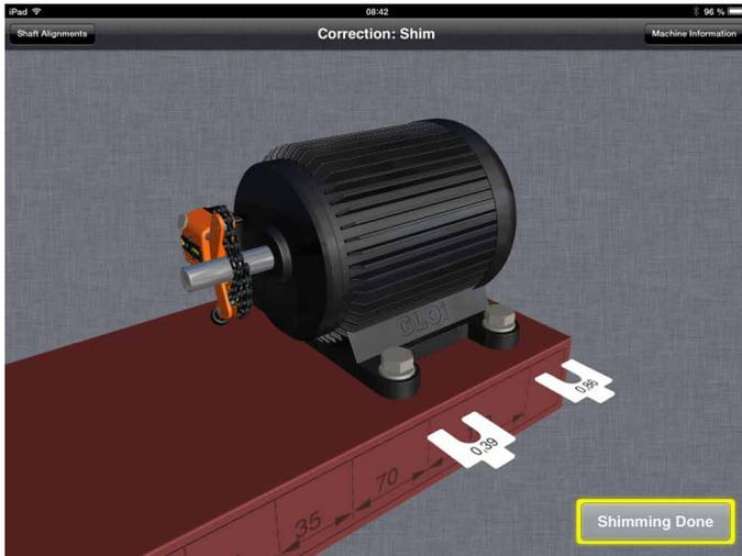
Le logiciel montre les cales à rajouter ou à enlever pour corriger l'alignement dans le plan vertical de la machine grâce à une animation.
