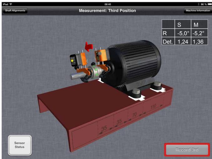
Déplacez la machine à l'écran pour une vue 3D sur mesure. Le logiciel interne vous guide dans la procédure de mesure d'alignement. Vous pouvez prendre 3 points de mesure à 9-12-3H ou s'il y a limite de rotation, sur un minimum de 20°+20°.
