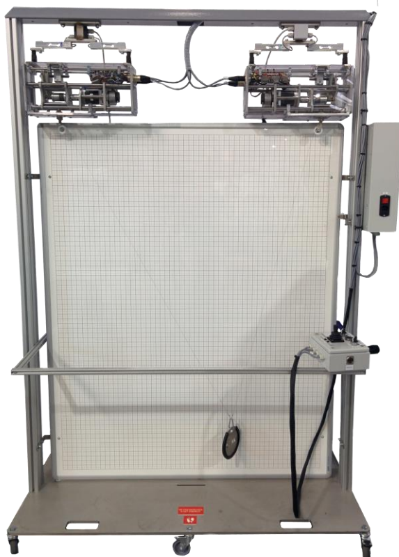
Vue du robot à câbles avec 2 têtes d'enroulages
