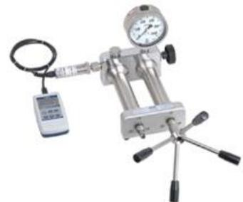
Exemple de kit complet pour étalonnage
