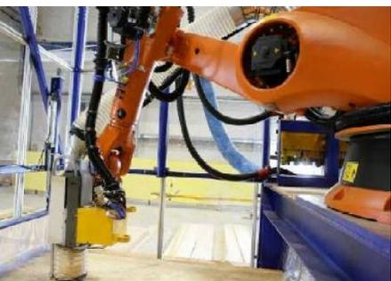
*Application industrielle: Sciage, Perçage, Encollage et Ponçage de plans de bois pour maisons préfabriquées*
