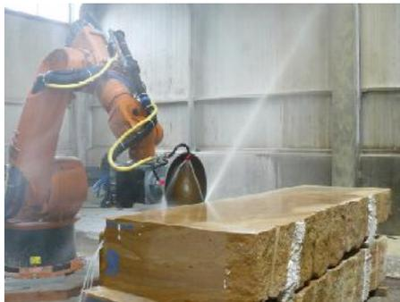
*Application industrielle: Sciage et perçage de blocs de pierre*
