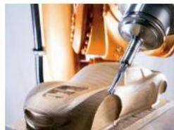
Avantages d'un usinage par robot sur base Kuka.CNC
