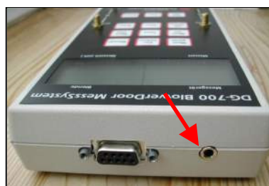
Raccordement du câble au DG-700
