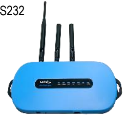
PR22 – Passerelle LoRa WAN « The Things Network »
