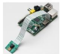
PR05 - Kit de développement RaspBerry avec caméra et microphone
