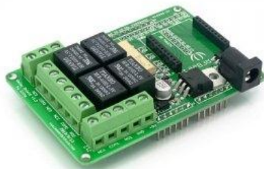
Figure 29 - PR50 Carte de 4 relais à commande opto-isolée
