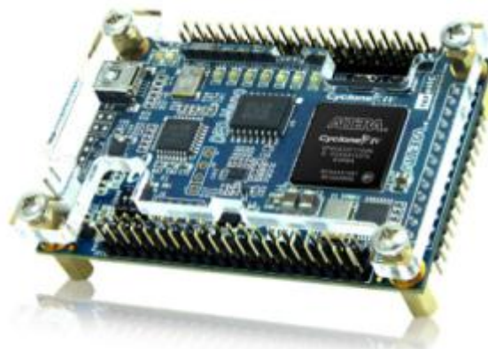
Figure 5 - PR03 : carte FPGA Altera DE0 Nano
