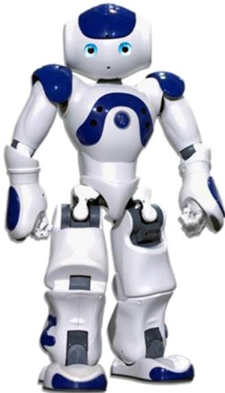
La cheville est constituée de trois sous-ensembles, tibia, cheville et pied, liés par deux pivots d'axes orthogonaux, roulis et tangage, animés par des ensembles moteurs électriques et réducteurs à engrenages.
