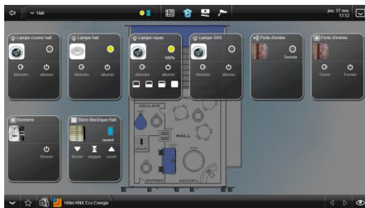
Ecran de commande des éléments de la face Hall. Indication de l'état des luminaires, de la porte, du store et de la sonnerie
