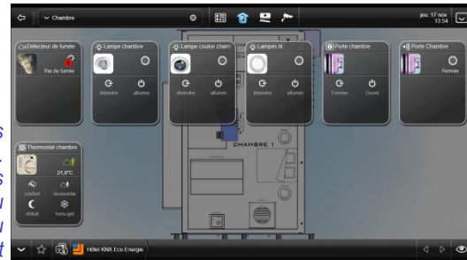
Ecran de commande des éléments de la face chambre. Indication de l'état des luminaires, de la porte, du détecteur de fumée et du thermostat
