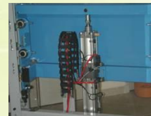
Motorisation pneumatique: 2 Vérins double effet (utilisés en simple) montés en tandem
