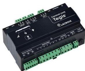
Contrôleur Tegis Lighting Plus
