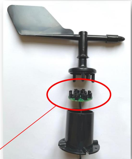
La carte électronique didactique du capteur Girouette est conçue pour intégrer des points tests et donner la possibilité de souder des composants traversants et en CMS.
