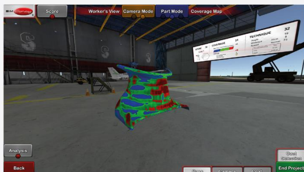
Vérification de l'application de la bonne épaisseur de peinture
