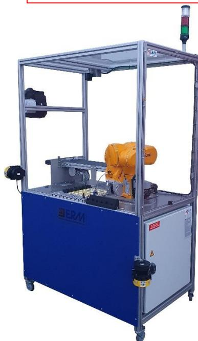
Station Robot & Vision Staubli avec convoyeur et Tracking vision
