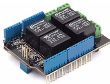
PR50 : Carte de 4 relais à commande opto-isolée
