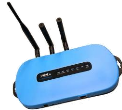
PR22 – Passerelle LoRa WAN « The Things Network »
