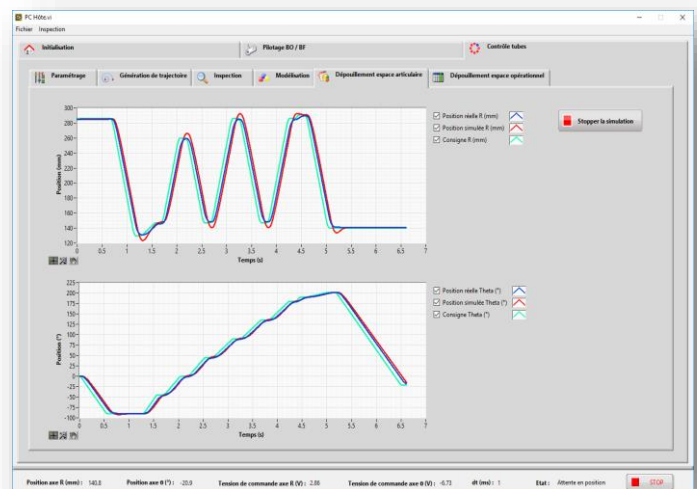
Comparaison des courbes de comportement, souhaité, simulé et réel
