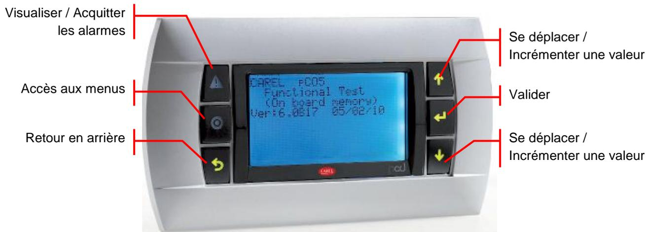
A la mise sous tension du coffret électrique, l'automate s'initialise puis quelques secondes plus tard l'interface opérateur affiche l'écran suivant :
