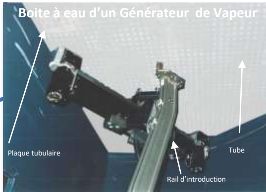
BRAS BETA en situation de d'introduction dans la boite à eau d'un Générateur de Vapeur
