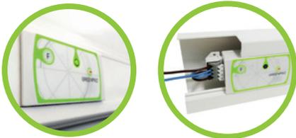
Module capteur et actionneur pouvant être directement clipsé dans une goulotte format 45. Il peut également être utilisé dans les faux-plafonds avec son système d'accroche intégré. Il s'intercale entre le disjoncteur divisionnaire et la charge qu'il protège. Le raccordement se fait par le côté pour l'alimentation et pour le départ.
