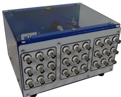
Ce coffret permet le contrôle / commande des convertisseurs électroniques de puissance multifonctions. la face avant est dotée douilles BNC pour la partie pilotage (entrées analogiques différentielles, entrées numériques et sorties numériques) et la face arrière est dédiée à l'alimentation et la communication du système (USB, RJ45, alimentation 12V et Vref pour les sorties numériques).
