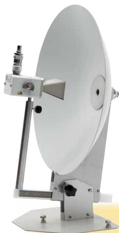
**L'ensemble d'étude de l'antenne parabolique E ANP 100**, comportant le réflecteur parabolique ANP 100 est réglable en site. La position de sa source, un cornet de 10 dB de gain est réglable sur l'axe focal. Le socle de cet ensemble, équipé de 3 vis imperdables peut être fixé indifféremment sur le bâti d'expérimentation ou sur le plateau tournant. Le Réflecteur parabolique existe aussi en modèle fixe sans réglage ANP 100 F.
