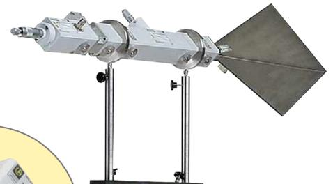
L'étude de la polarisation de l'onde électromagnétique est facilitée par le **positionneur PEH 100** qui fait tourner progressivement la polarisation de l'onde sur 360°.
