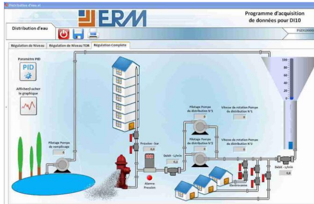
Exemple de synoptique Labview de la régulation complète (niveau, débit, pression)
