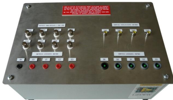
Coffret avec carte USB d'entrées/sorties analogiques et logiques
