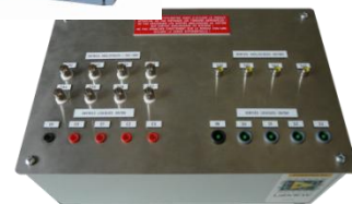
Coffret de commande avec carte d'entrées/sorties analogiques et logiques National Instruments
