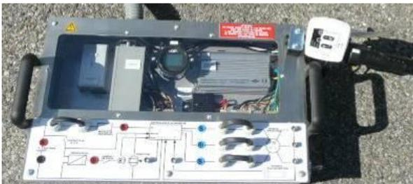
💡 : C'est un "Vélo à Assistance Electrique". Par conséquent, l'assistance électrique n'est enclenchée que si le pédalier est actionné (pédalage d'un utilisateur indispensable durant la phase de test du système). De plus, le moteur se débraye automatiquement au delà d'une vitesse de 25 Km/h (l'assistance électrique se coupe si vitesse du véhicule > à 25 Km/h)
