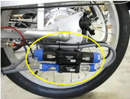
👍 : Visualisation et mise en œuvre des composants électronique de pilotage facilitée. Composants électroniques de pilotage doublés : "Composants embarqués" + "Composants "identiques" dans coffret de pilotage/mesurage déporté" (Contrôleur, Compteur, Accélérateur, poignée de frein,...).
