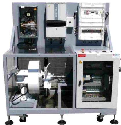
Le système ED10 « Banc de caractérisation d'éolienne 3kW » permet de mettre en œuvre une éolienne 3kW en situation de réinjection réseau.
