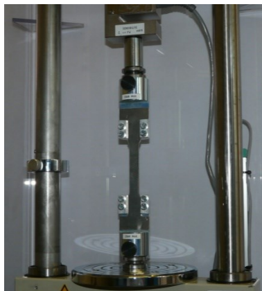
Test avec éprouvettes plates (EM24)
