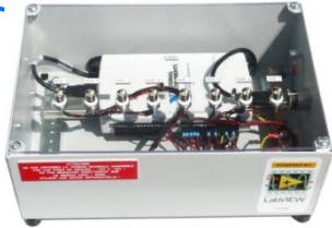
Boîtier d'acquisition de la centrale USB AQ10
