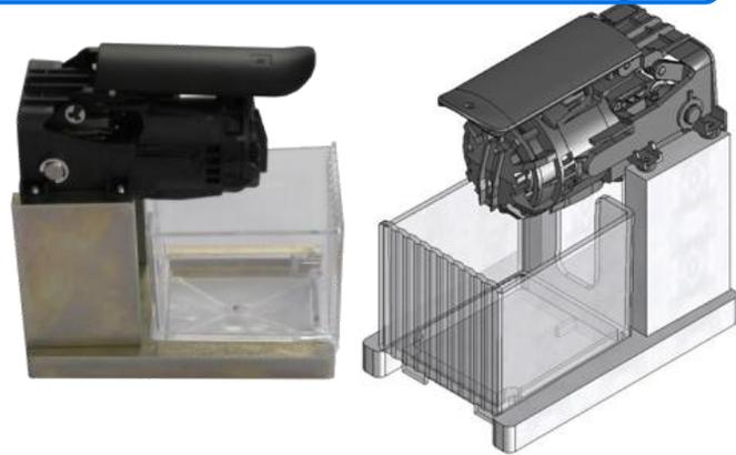
*Sous-ensemble mécanique de prise en charge et perçage de capsules sur socle équipé d'un dynamomètre*
